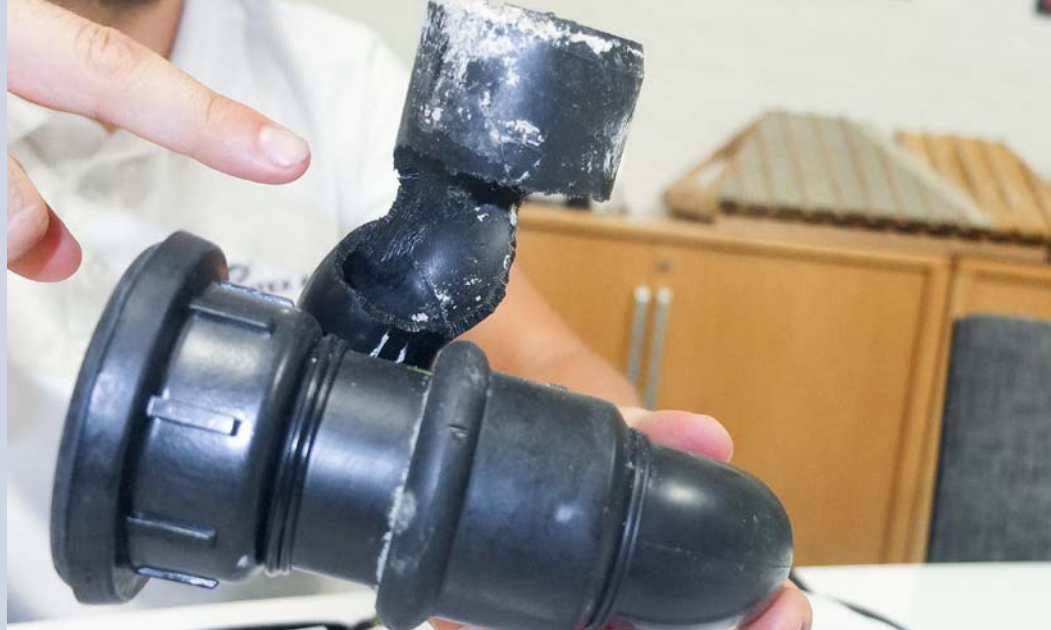
Auch da waren Nager am Werk.
