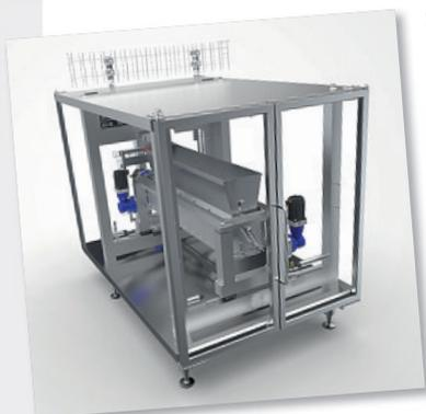
SACMI Packaging & Chocolate präsentiert eine neue Lösung für die Herstellung von Halbfertigprodukten auf Schokoladenbasis. Das Punkt-Dosiersystem MLRG 1500 unter der Marke Carle & Montanari ermöglicht die Herstellung von Schokoladen-Halbfabrikaten in Form von Drops, Disks, Sticks
