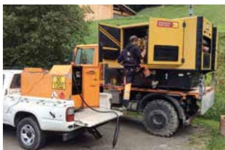
Abb. 2a: Zwei Dieselgeneratoren à 70 kW und 80 kW auf dem Unimog und Dieseltank auf dem Pick-up.
