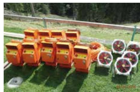
Abb. 2b: Sechs Wärmeentwessungsöfen (=WEO) à 18 kW und 3 WEO à 9 kW von ThermoNox®, Ventilatoren und Verlängerungskabel.
